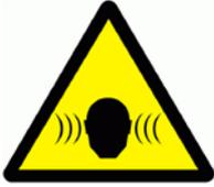
Высоковольтные разряды трансформатора Тесла сопровождаются сильным шумом. Не рекомендуется находиться вблизи работающего трансформатора более 20-30 минут. При длительном времени использования устройства нужно применять защитные наушники и устраивать перерывы.
